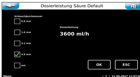
Diese Einstellungen können nur in Benutzerebene 2 ausgeführt werden. Die hier eingestellten Werte sind abhängig von der Bauart des Dosiergerätes. Die Werte sind vom Werk voreingestellt und dienen als Grundlage für die Dosierberechnungen.
