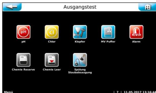
Der Ausgangstest dient zur Überprüfung der angeschlossenen Ausgänge (Pumpen, Motoren und Relais). Der gewählte Ausgang wird für 30 Sekunden angesteuert. Die Ansteuerung kann jederzeit mit **Stopp** abgebrochen werden.
