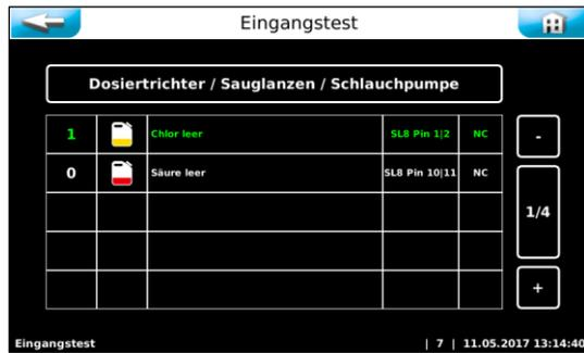
Der Eingangstest dient zur Überprüfung der angeschlossenen Eingänge (Schalter). Die wechselnde Betätigung der Schaltereingänge, wird mit einer 0 (offen) bzw. 1 (geschlossen) angezeigt.
