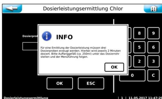
Die Ermittlung der effektiven Dosierleistung ist erforderlich für die Berechnung des Chemikalienverbrauchs und somit auch für die Berechnung der Reservemeldung.
