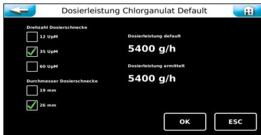
Diese Einstellungen können nur in Benutzerebene 2 ausgeführt werden. Die hier eingestellten Werte sind abhängig von der Bauart des Dosiergerätes. Die Werte sind vom Werk voreingestellt und dienen als Grundlage für die Dosiermengenberechnung und Reserveanzeige. Die angezeigten Defaultwerte werden nach einer komplett durchgeführten Dosierleistungsermittlung, durch die ermittelten Dosierleistungen überschrieben.
